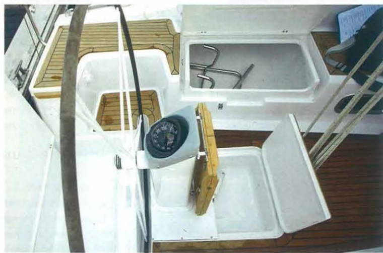
GRABEN Der Anker lagert im Galgen, die Kette im tiefen Stauraum. Die Winsch ist ein Extra und der Anbau nicht vorbereitet
