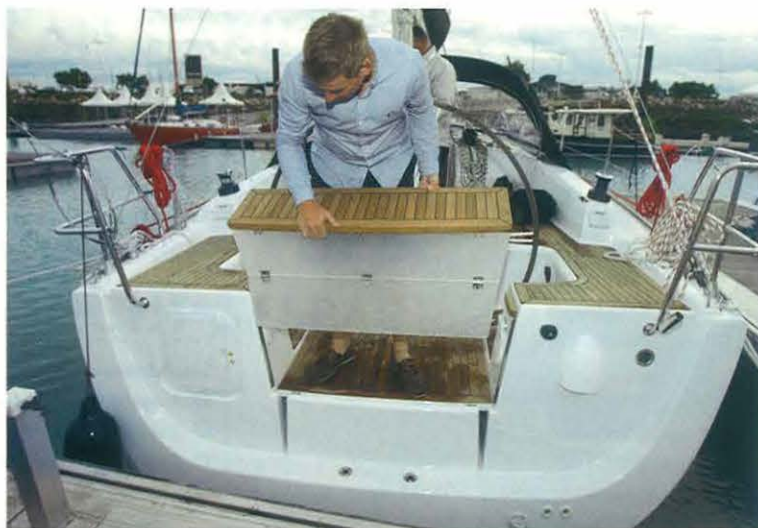
BRÜCKE Statt aufwändiger Heckklappe wird der Spiegel mit einem Steckschott geschlossen. Das Teakteil oben dient als Sitz
